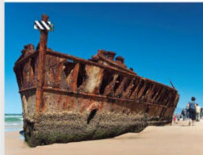
**Figura 4.26.** La oxidación en los barcos provoca grietas por donde puede entrar agua, con lo que se vuelven inservibles.
