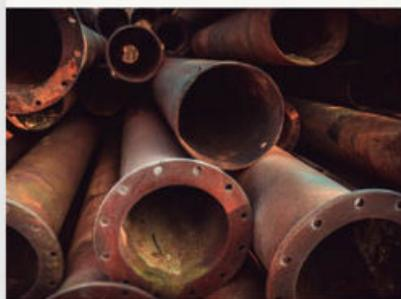
**Figura 4.35.** Los tubos a la intemperie son propensos a sufrir corrosión por el ambiente.
