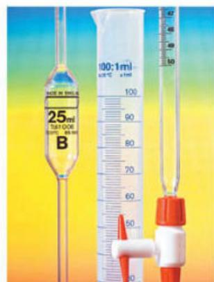
**Figura 1.14.** Diferentes instrumentos para medir volúmenes.
