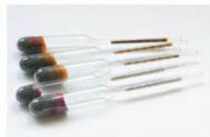
**Figura 1.16.** El densímetro consiste en un bulbo pesado que posee un cilindro hueco que sobresale de la superficie del líquido; a mayor densidad del líquido, menos se hunde el cilindro. El cilindro está graduado en unidades de densidad.
