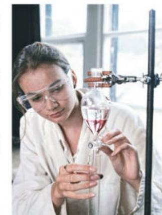
**Figura 1.25.** Dispositivo para la decantación de dos líquidos de diferente densidad.
