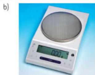
**Figura 1.13.** a) Balanzas granataria y b) analítica, instrumentos para medir masa.
