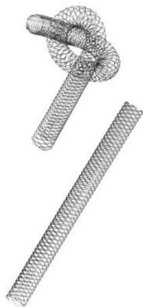
**Figura 2.24.** El nitinol es una aleación que regresa a su forma original con facilidad.
