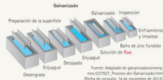
**Figura 4.36.** La galvanización es un proceso que se emplea para cubrir un metal con otro y protegerlo contra la corrosión.
