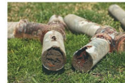
Tuberías tapadas con incrustaciones de carbonato de calcio ( $\text{CaCO}_3$ ).
